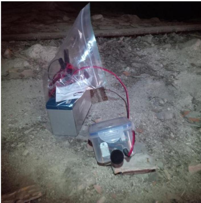
Des thermomètres-hygromètres ont été posés en complément pour comprendre le lien entre présence des chauves-souris et paramètres climatiques.
